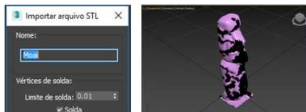
Figura 6: Tratamento do arquivo STL no 3ds Max: janela com opções para importação do arquivo STL (esquerda) e modelo importado com valor de 0,05 para limite de solda (direita)
